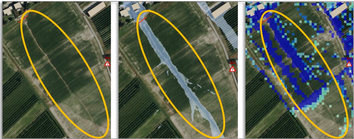
Abb. 39: Erosionsschäden lassen sich nicht nur kurz nach einem Ereignis beobachten, sondern können sich beizeiten auch gut in Luftbildern widerspiegeln (hier: Reinacherweg in Efringen-Kirchen, links: Luftbild, Mitte: Luftbild mit Wasserabfluss aus Starkregenkarte, rechts: Luftbild mit Sedimentation aus Erosionskarte).
